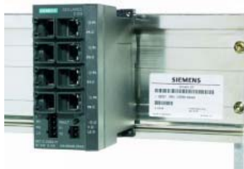
Bild 3-3 SCALANCE X-100 Montage auf einer SIMATIC S7-300-Profilschiene
