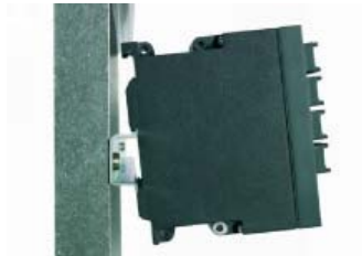
Bild 3-2 SCALANCE X-100 Demontage von einer DIN-Hutschiene (35 mm)
