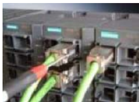
Bild 4-8 Entriegelung des RJ45 Plug mit Schraubendreher
