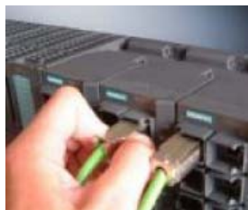
Bild 4-7 Entriegelung des RJ45 Plug
