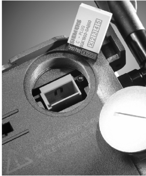
Рис 4.13 Удаление модуля C-PLUG из отсека
