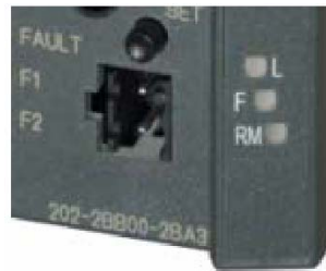
Рис 4.24 Сигнальный контакт в SCALANCE X202-2IRT
