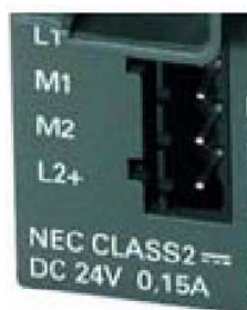
Рис 4.15 Гнездо для подключения источника питания модуля SCALANCE X204-2
