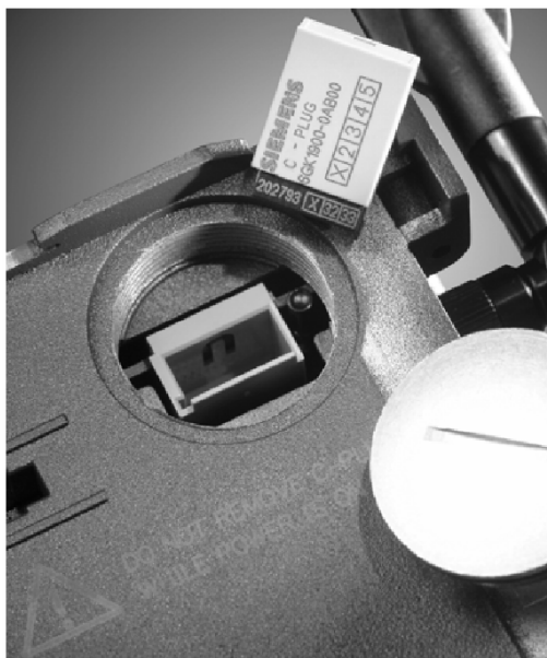
Рис 4.21 Удаление модуля C-PLUG из отсека
