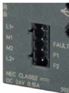
Рис 4.23 Гнездо для подключения источника питания модуля SCALANCE X202-2IRT
