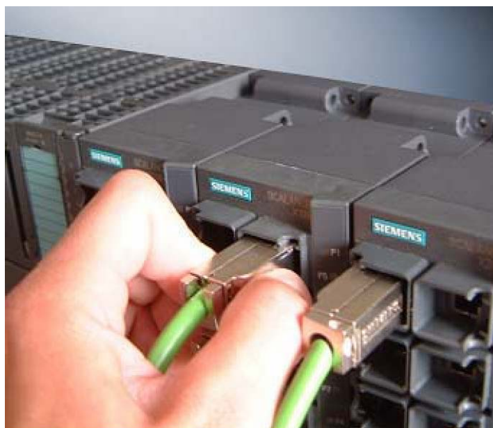
Рис. 5.6 Отсоединение штекера IE FC RJ-45 Plug 180
