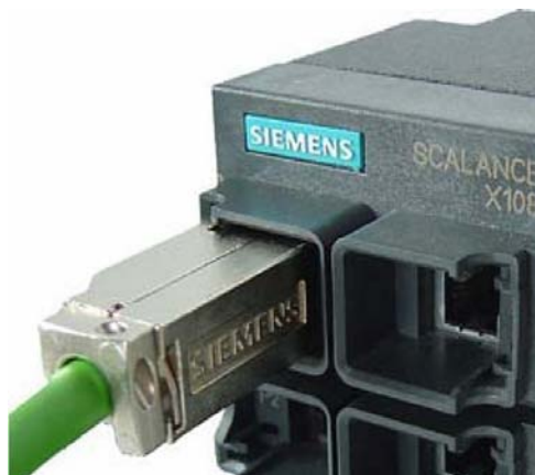
Рис. 5.5 Вставка в разъем штекера IE FC RJ-45 Plug 180
