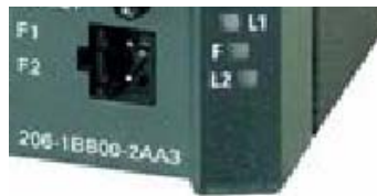
Рис 4.20 Сигнальный контакт в SCALANCE X206-1
