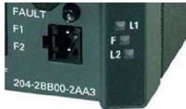
Рис 4.16 Сигнальный контакт в SCALANCE X204-2
