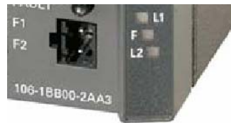
Рис 4.9 Сигнальный контакт в SCALANCE X106-1
