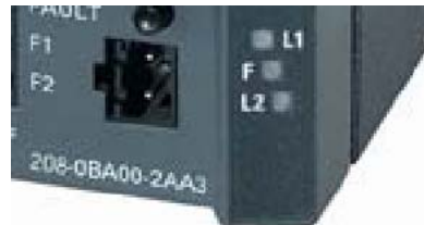
Рис 4.12 Сигнальный контакт в SCALANCE X208
