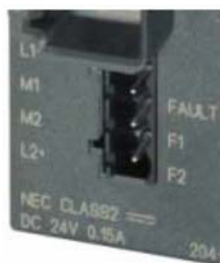
Рис 4.27 Гнездо для подключения источника питания модуля SCALANCE X204IRT
