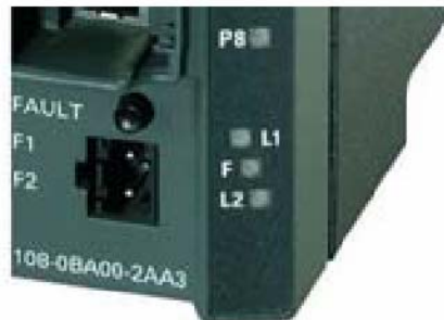
Рис 4.3 Сигнальный контакт в SCALANCE X108
