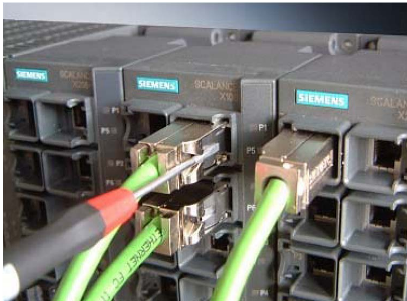
Рис. 5.8 Отсоединение штекера RJ-45 с помощью отвертки
