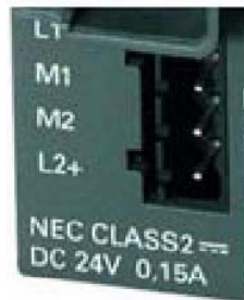
Рис 4.5 Гнездо для подключения источника питания модуля SCALANCE X104-2
