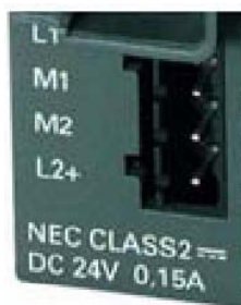
Рис 4.11 Гнездо для подключения источника питания модуля SCALANCE X208
