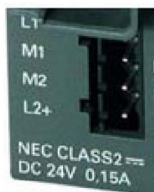
Рис 4.8 Гнездо для подключения источника питания модуля SCALANCE X106-1
