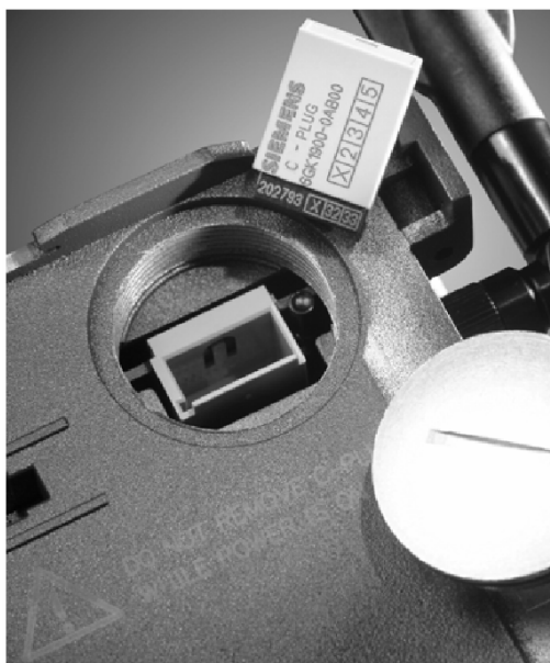
Рис 4.17 Удаление модуля C-PLUG из отсека
