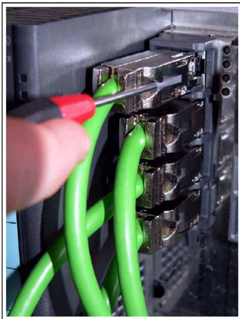
Рис. 6.17 Освобождение штеккера RJ-45 кабеля FastConnect
