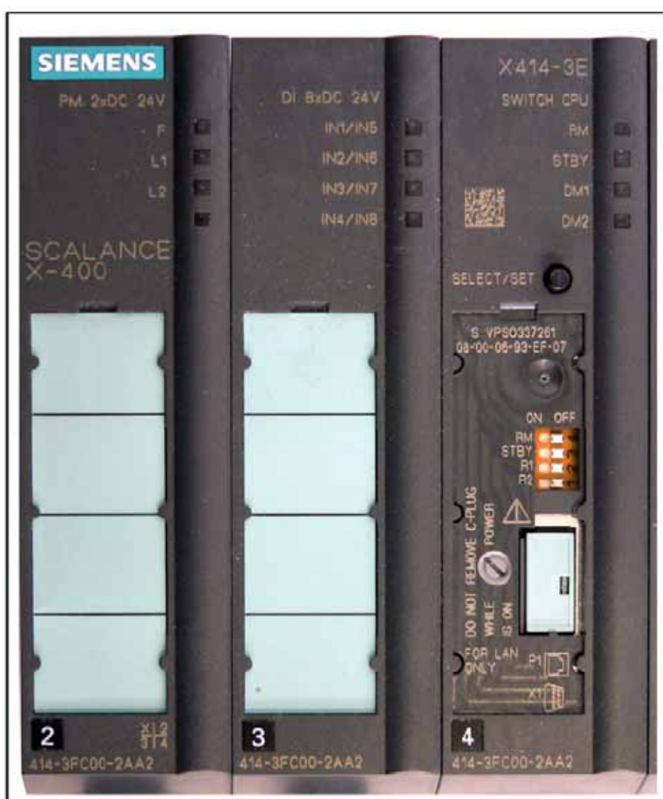
Рис. 6.20 Силовой модуль (Power module), модуль цифровых входов (DI-модуль) и процессорный модуль (Switch CPU) с открытыми органами управления
