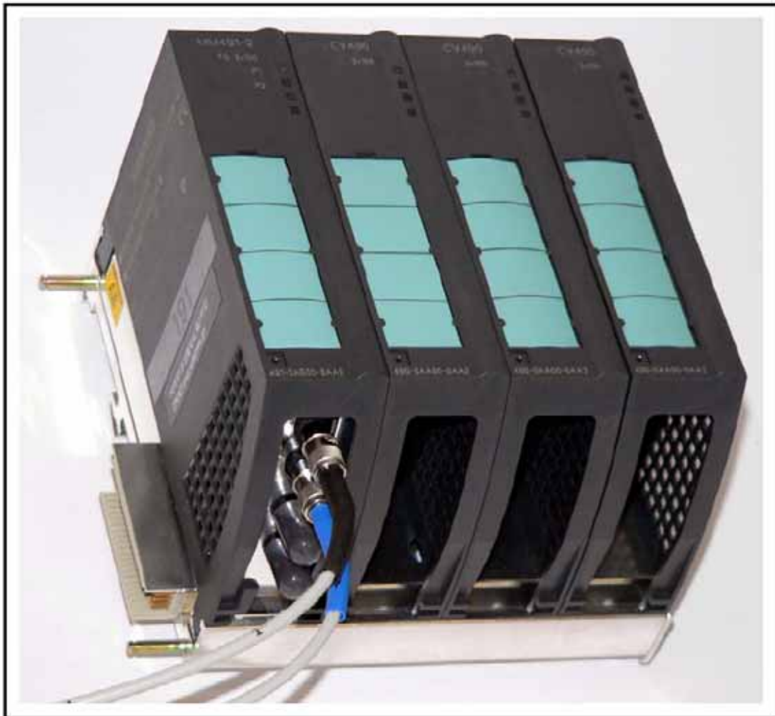
Рис. 5.5 Модуль расширения EM496-4 с подключенным медиа-модулем MM491-2 в слоте 12 и с надетыми защитными кожухами.
